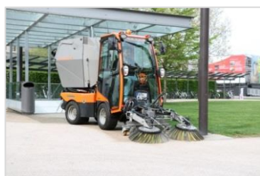
Holder X45 – mit seinen kompakten Maßen und seiner Wendigkeit ist er optimal geeignet zum Einsatz in Innenstädten und Tiefgaragen (Foto: Max Holder GmbH)
